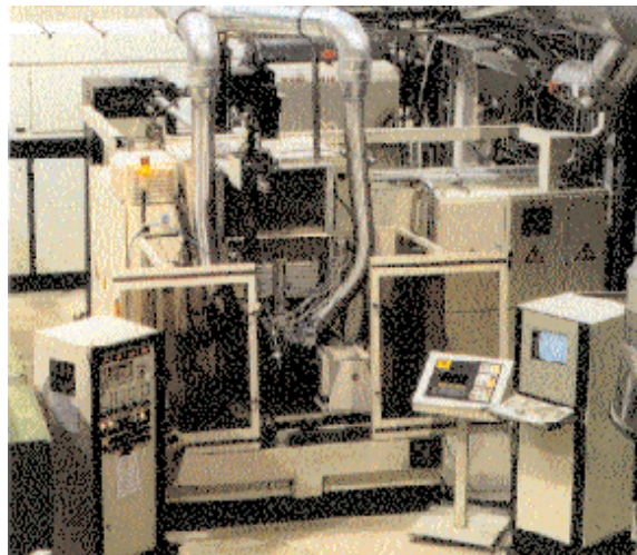
Fig. 3: Multi-purpose laser-induction processing center LIHM 1000; Manufacturer: EFD Induktionserwärmung Fritz Duesseldorf GmbH, Freiburg, Germany
